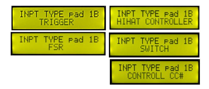
TRIGGER FSR SWITCH CONTROL CC# HiHAT CONTROLLER PRESSURE CONTROLLER
